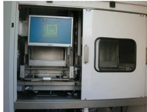
L'un des deux fours à air pulsé.
